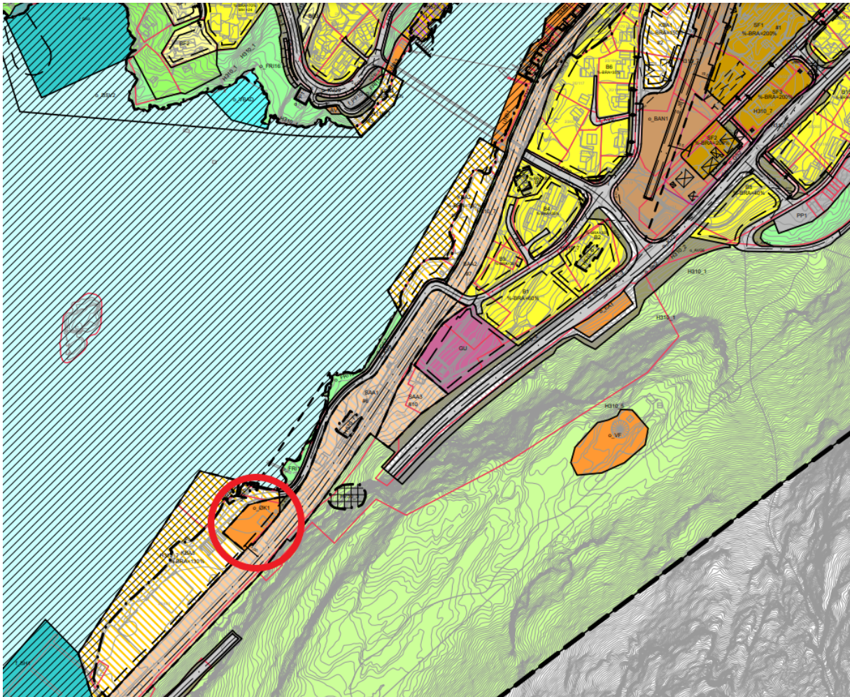
Figur 11 Utsnitt frå gjeldande områdeplan for Stanghelle med plassering av reinseanlegg
